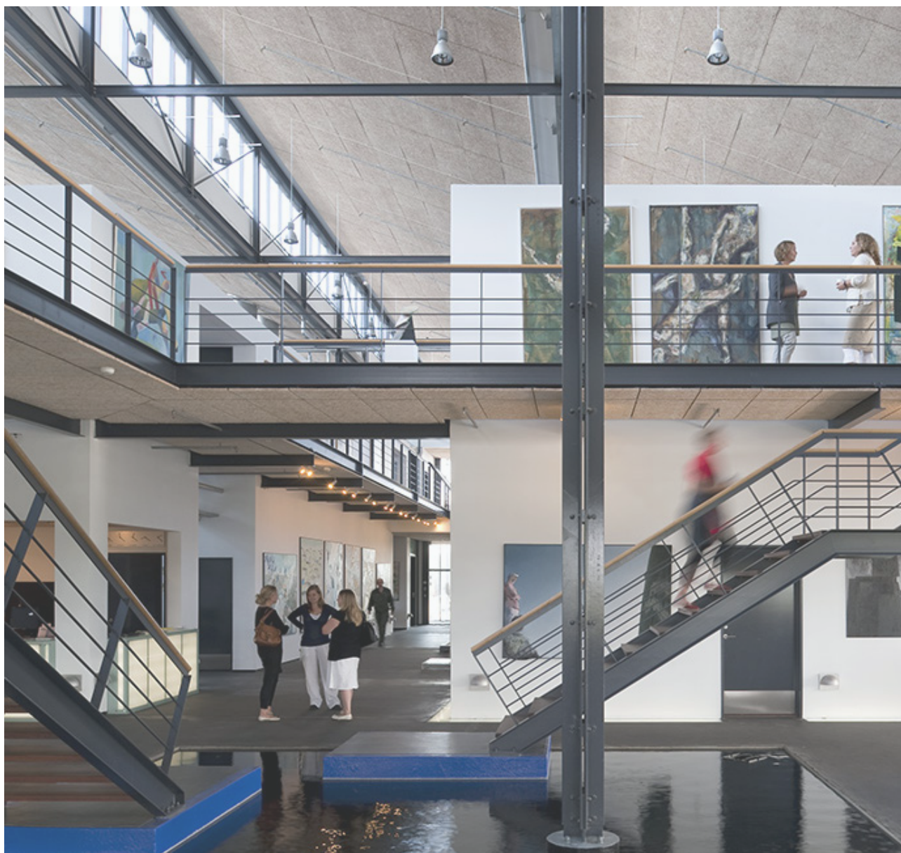
I 2004 begyndte transformationen af en erhvervs- og industribygning til kommunens nye rådhus. Bygningen er kvadratisk og opført i enkelt konstruktivt system af stål og beton og med facader i træ og trælameller.
